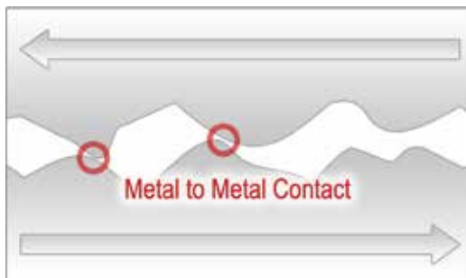
Abb. 1: Unebenheiten auf sich berührenden Metalloberflächen
